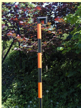
➤ zakončení - silnostěnná 5/4 " Fe trubka
